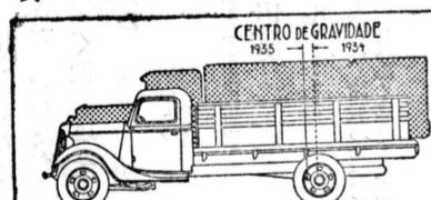
前車の挿條及モーターは、以前より車體の前方に取付、車體の重心点を中央に移し、運転臺を廣くすると共に、後車との間隔を、16.5cm長くなり、故に制動器の動作は容易となり、ブネウの消費を節約し、車體其ものは以前より廣くなりました。
